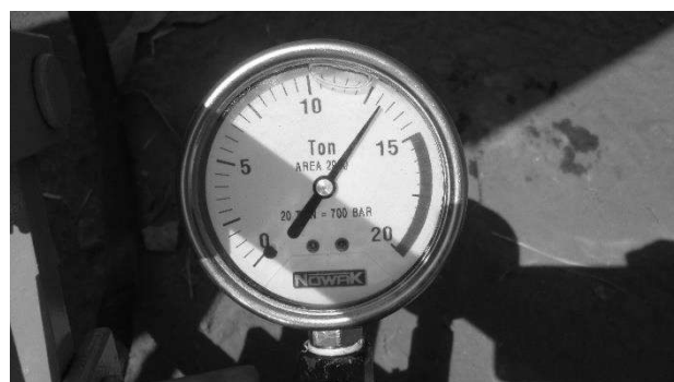
FOTO 08 – Carga em P2 = 12,0 Ton (127,5 KN)
