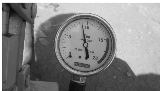
FOTO 06 – Carga em P3 = 9,0 Ton (88,3 KN).
