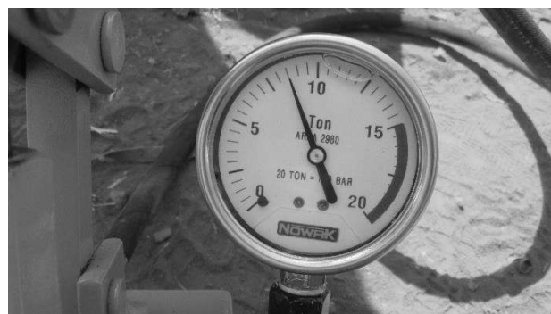
FOTO 04 – Carga em P1 = 8,5 Ton (83,4 KN).
